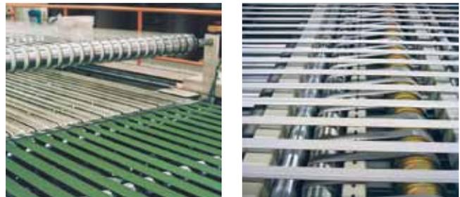
**Siegling Extremultus Maschinenbänder** sind in vielen industriellen Anwendungen unverzichtbare Maschinenelemente. Zugträger aus Polyestergewebe, Polyamidband oder elastischem Polyurethan qualifizieren sie für unterschiedlichste Einsatzbereiche.
